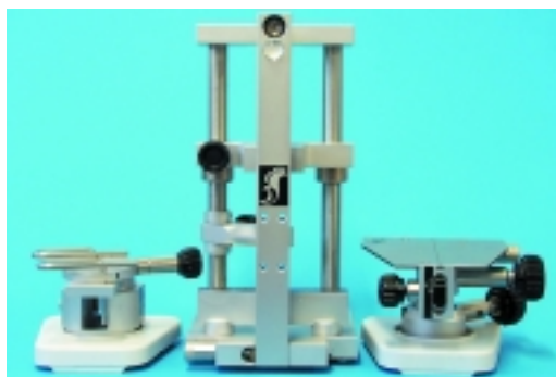
Abb. 5: Die Ortho-Gerätserie für die Umsetzung der STAUB™ CRANIAL-Technologie besteht aus drei Elementen, dem Positionierer Ortho1A (Mitte), dem Einbaustativ Ortho2A (links) und dem Cranialstativ Ortho3A.
